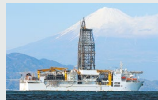
図3 地球深部探査船ちきゅう（海洋研究開発機構） 水深3000メートルの海底から6キロメートルを掘削する能力をもつ世界最大の科学掘削船。究極の目標はマントル掘削である。
