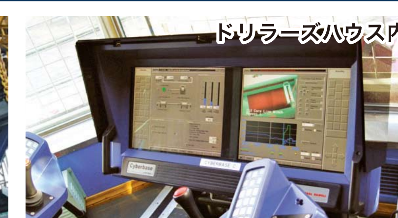
ドリラーズハウス内 掘削装置自動化:ドリラーズハウス 内から掘削機器の遠隔操作が可能 ジョイスティック・ボタンにより、屋外 掘削機器等を操作
