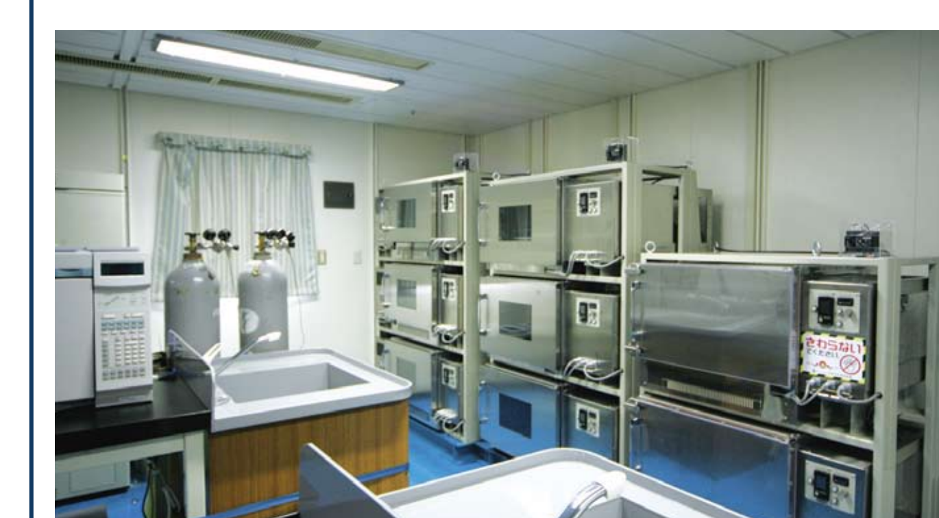
微生物実験装置 嫌気状態でサンプル採取・凍結保存・及び培養する装置
