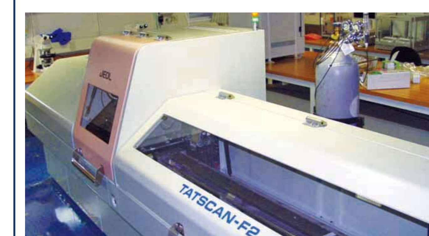
蛍光X線コアロガー コア表面に含まれる元素を非破壊で分析する装置
