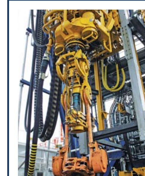
パワースイベル 降下したドリルパイプを 回転させる装置
