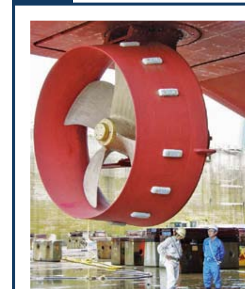
アジマススラスト 360度回転できる プロペラ(直径約4m)
