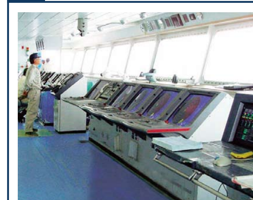
船内の様子が各種モニターでわかる。 DPSのコントロールはここで行う
