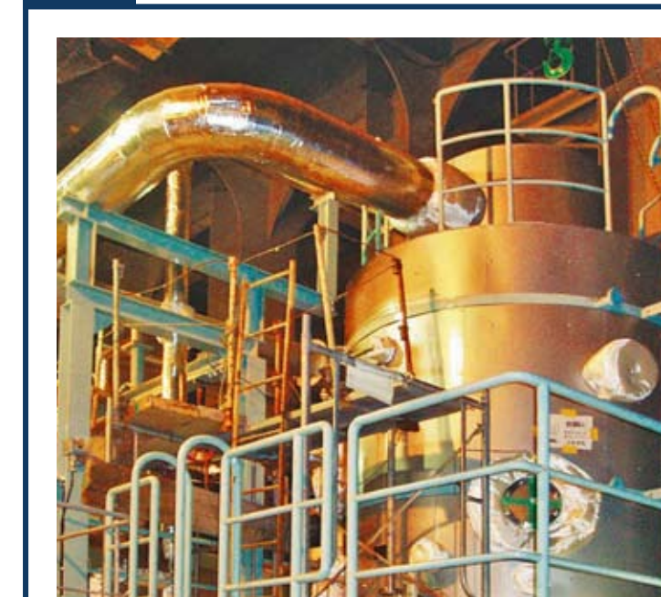
廃泥水処理装置 泥水を濃縮する装置
