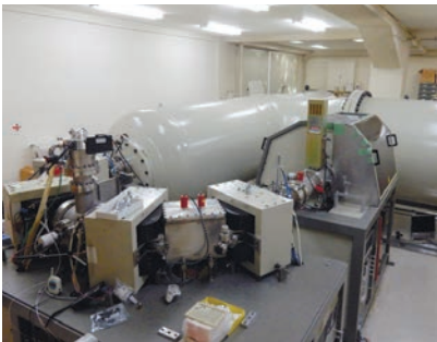
^{14}\text{C} を高精度に測定可能なタンデロン加速器質量分析装置
